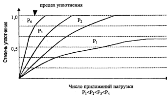
Рис. 4. Влияние величины уплотняющей нагрузки на скорость достижения предела уплотнения
