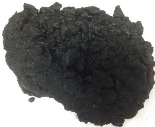
Рисунок А.2 — Смесь с битумной эмульсией, пригодной для приготовления органоминеральных смесей по показателю обволакиваемости
