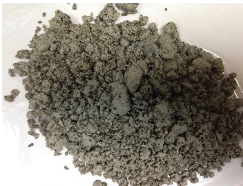
Рисунок А.1 — Смесь с битумной эмульсией, не пригодной для приготовления органоминеральных смесей по показателю обволакиваемости
